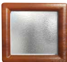
Oblò quadrato colore esterno quercia chiaro, interno bianco con tamponamento esterno trasparente in APET e interno opaco in CIPET dimensioni 290x290 mm o con vetro esterno di sicurezza 3+3 mm.
