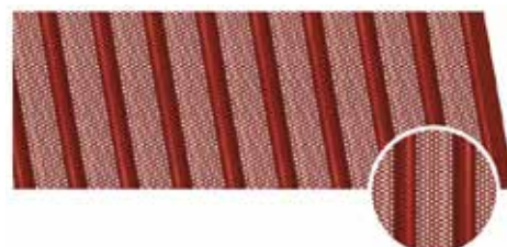
MICROFORATA Dimensione del foro Ø 7 mm Spessore 6/10 Areezione del manto circa 30%
