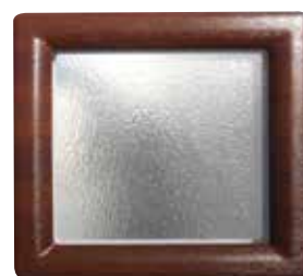
Oblò quadrato colore esterno quercia scuro, interno bianco con tamponamento esterno trasparente in APET e interno opaco in CIPET dimensioni 290x290 mm o con vetro esterno di sicurezza 3+3 mm.
